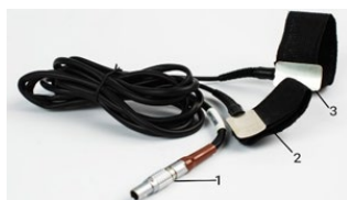
Рис. 1. Датчик КГР полиграфа «Диана»
